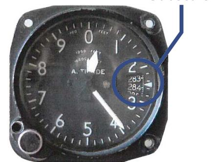
Obwohl der barometrische Höhenmesser nicht die tatsächliche Höhe über dem Grund anzeigt, eignet er sich hervorragend um Flugzeuge vertikal zu staffeln, wenn die Piloten denselben Luftdruck (in der Regel auf Meereshöhe) eingestellt haben. Vertikal gestaffelt werden die Flugzeuge nach sogenannten Flugflächen (engl. flight level, FL) in Schritten von 100 Fuß. FL 100 entspricht demnach 10.000 Fuß.
